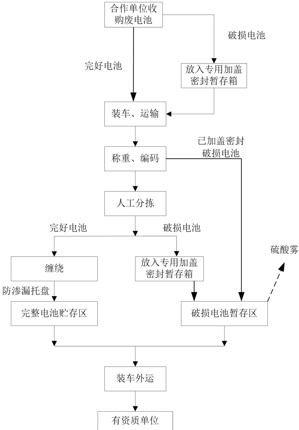
图2 项目生产工艺流程及产污环节图
