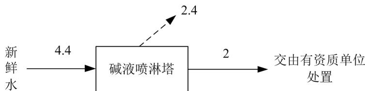
图 1 本项目水平衡图 单位： $\text{m}^3/\text{a}$
