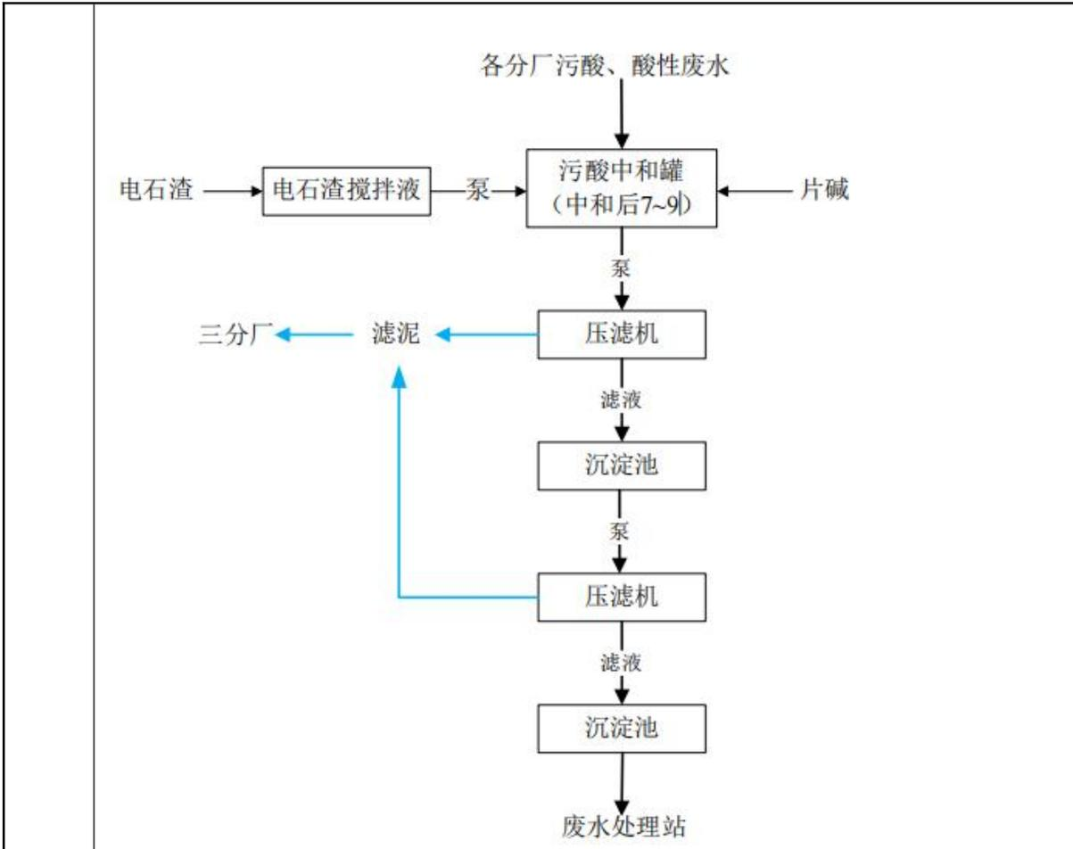
图 3 金利公司污酸处理站处理工艺简图
