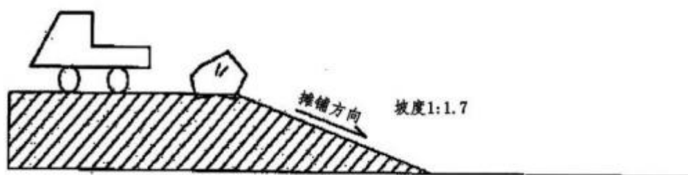
图2-14 摊铺作业方法示意图
