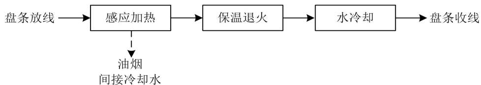
图 2.14 感应退火线工艺流程及产污环节示意图
