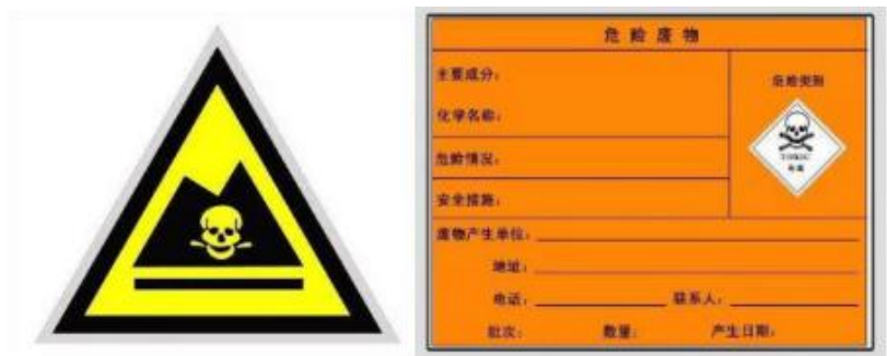
图 3 危险废物暂存场所警告及标签
