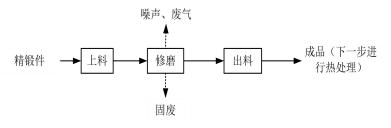
图1 项目生产工艺流程及产污环节图
