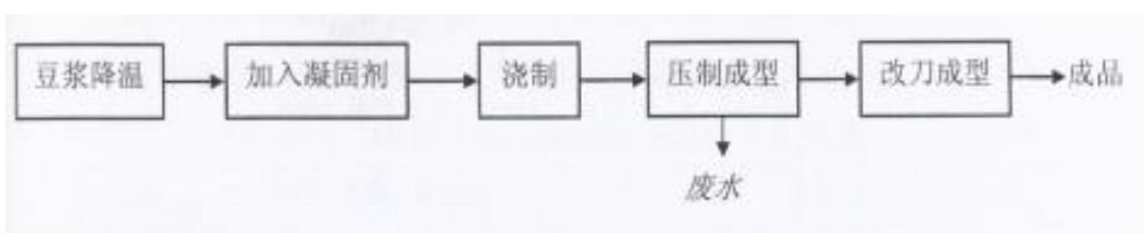
图 2-3 千张、豆干生产工艺及产污环节图
