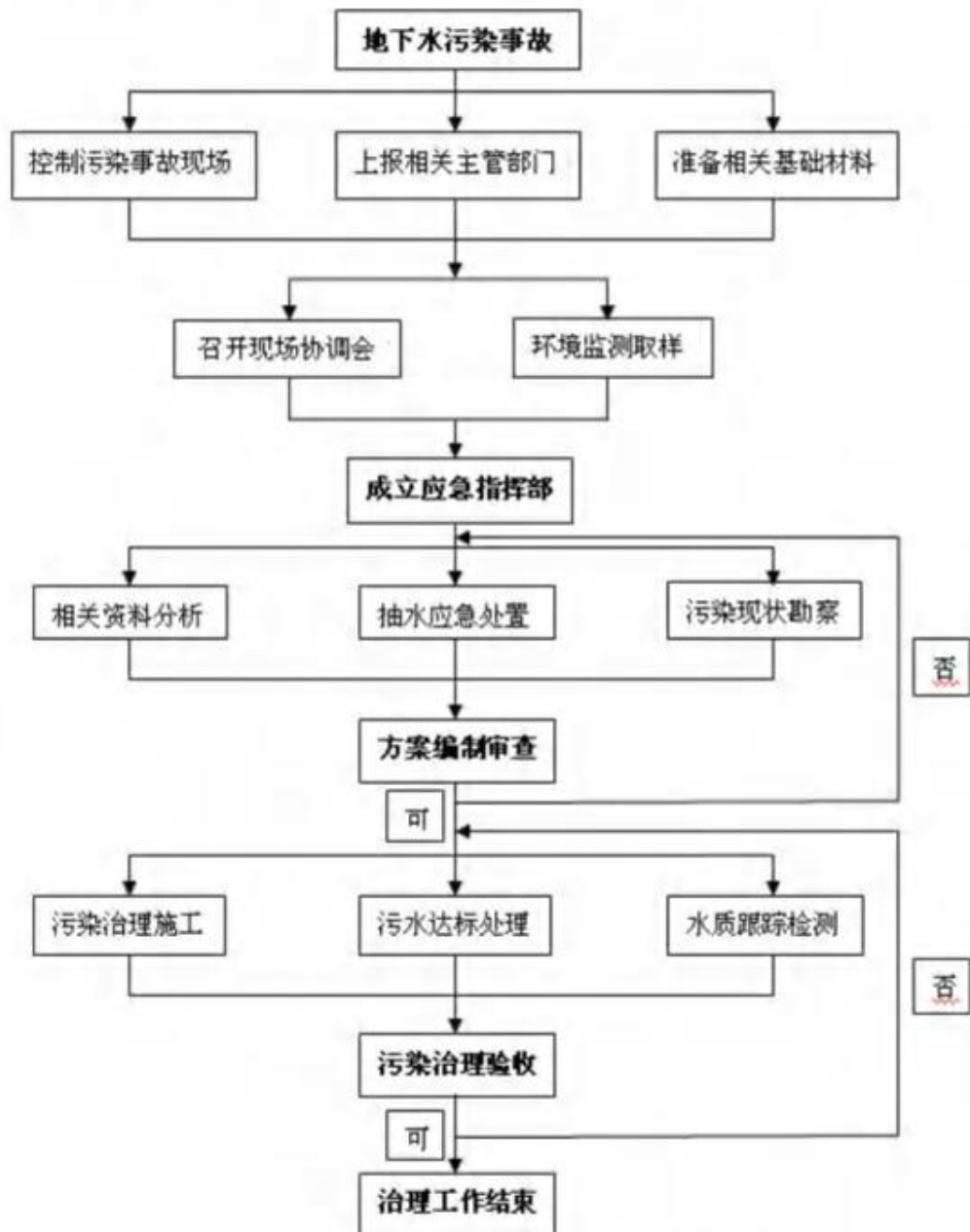
图 6.5-1 地下水污染应急治理程序图
