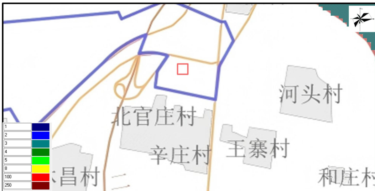
图 5.4-24 渗漏事故发生后 20 年硫酸盐污染晕运移分布图 (单位: mg/L)
