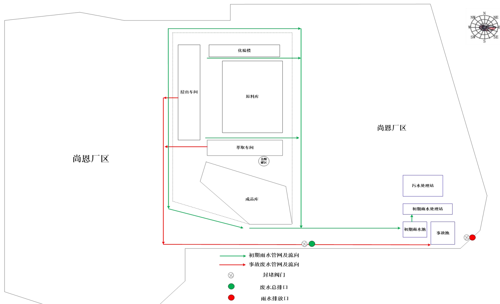
图 5-6 厂区事故废水收集管网示意图
