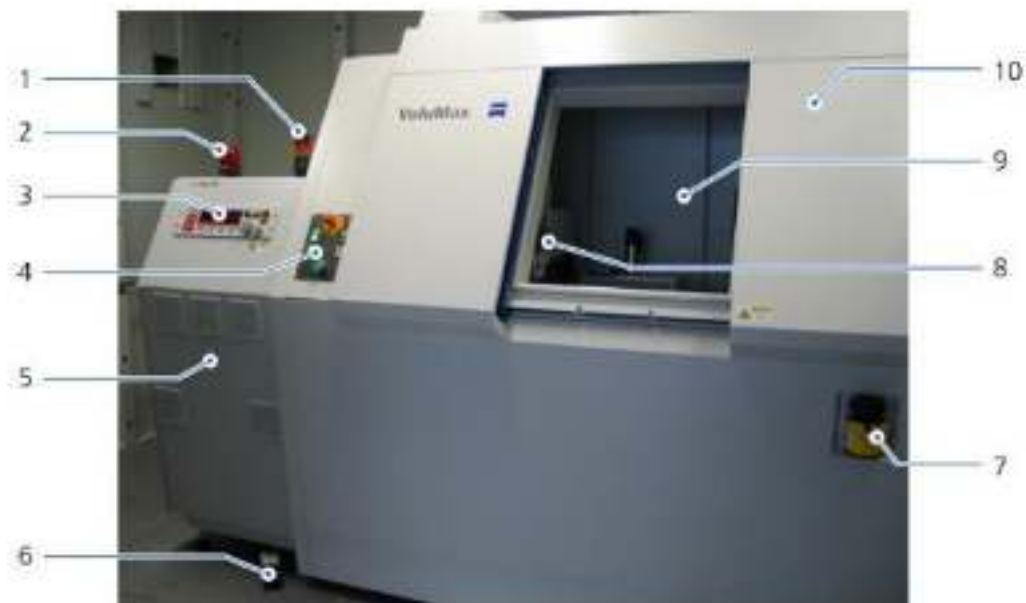
图 9-3 工业 CT 外部结构图
